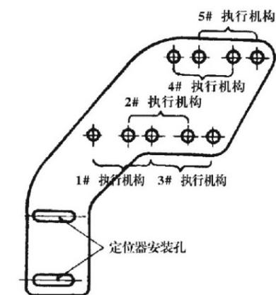
图8 ZM<sup>A</sup><sub>B</sub>型执行机构用安装板
