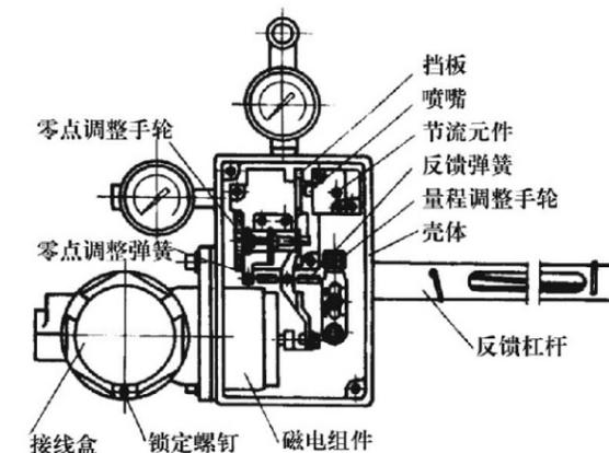
图2 HEP型定位器内部结构
