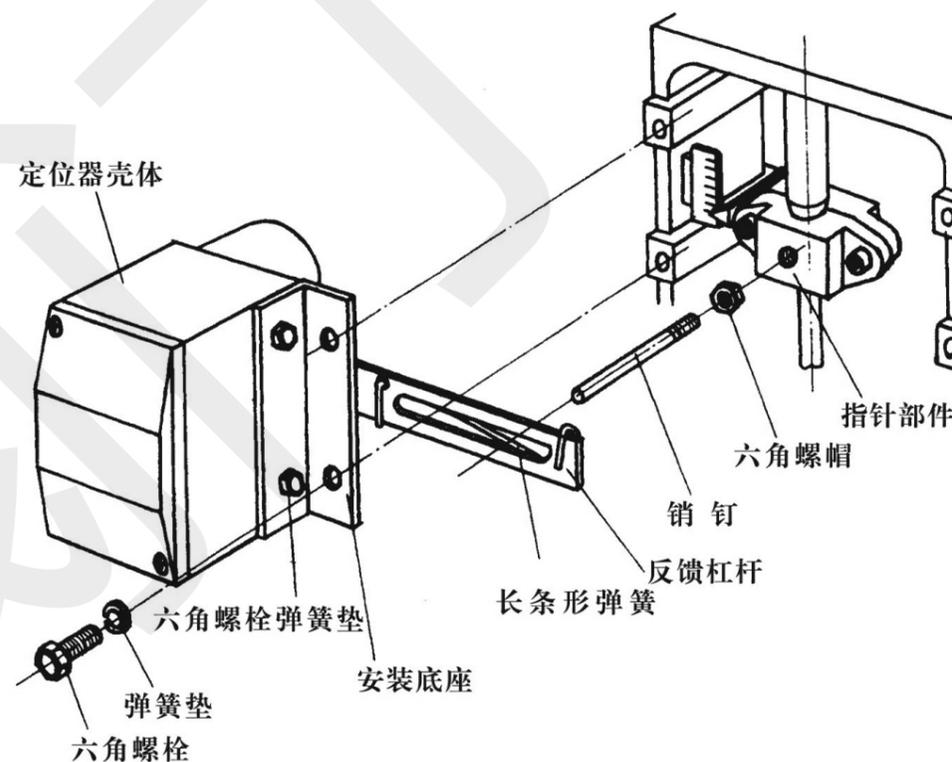
图4 定位器在ZHB<sup>A</sup>型执行机构上安装图
