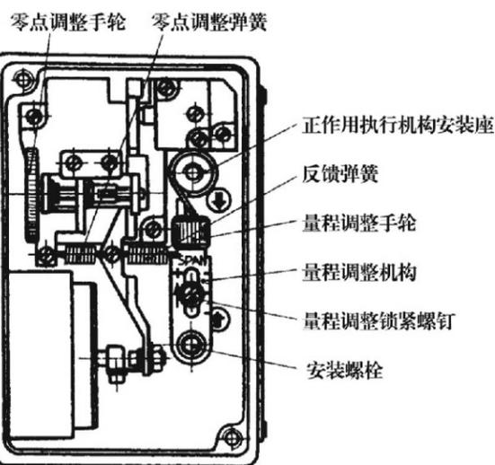
图11 零点和量程调整机构
